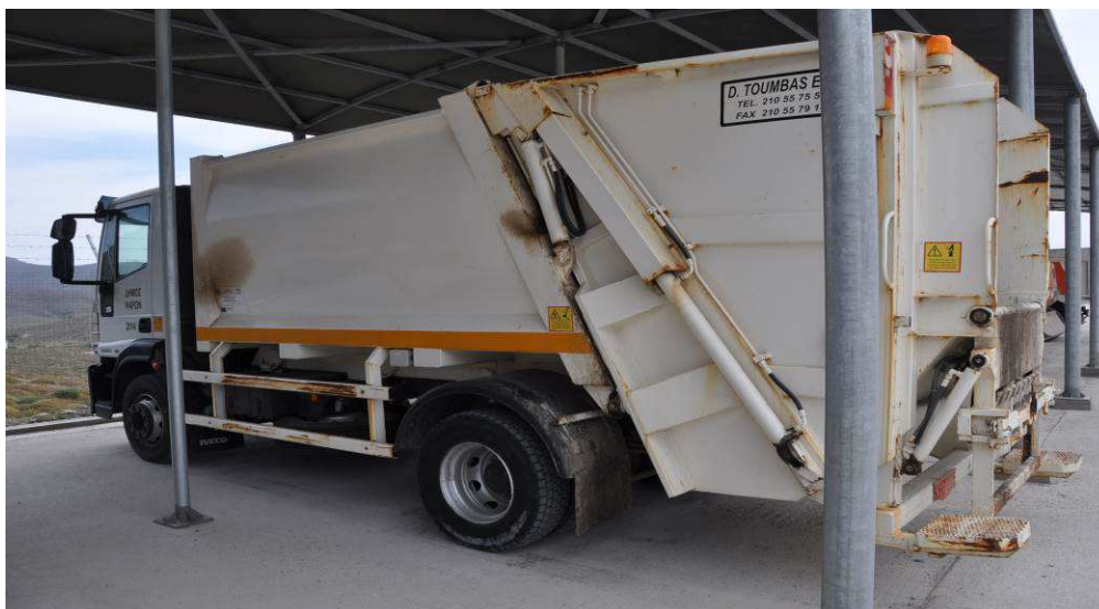
Εικ. 4.1: Απορριματοφόρο 8 κ.μ. (ΚΗΗ 2889), τύπου πρέσας
